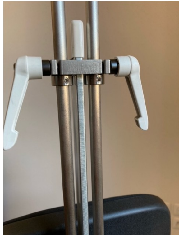
Image 21 : remonter les bagues jusqu'en butée contre la bride et les serrer. Ces bagues empêchent les arcs de sortir des trous du tambour, dans le cas où on ne serre pas les poignées pour profiter de la rotation des arcs (cas rare mais possible).
