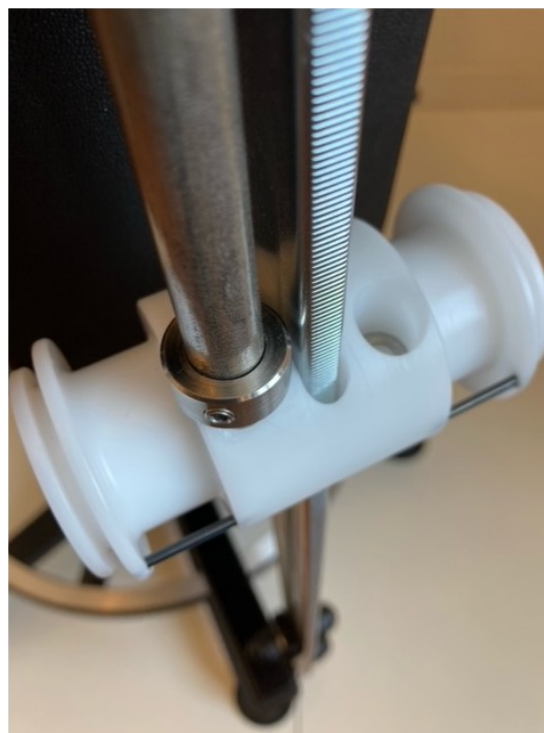
Image 19 : ne pas serrer la bague pour le moment.
