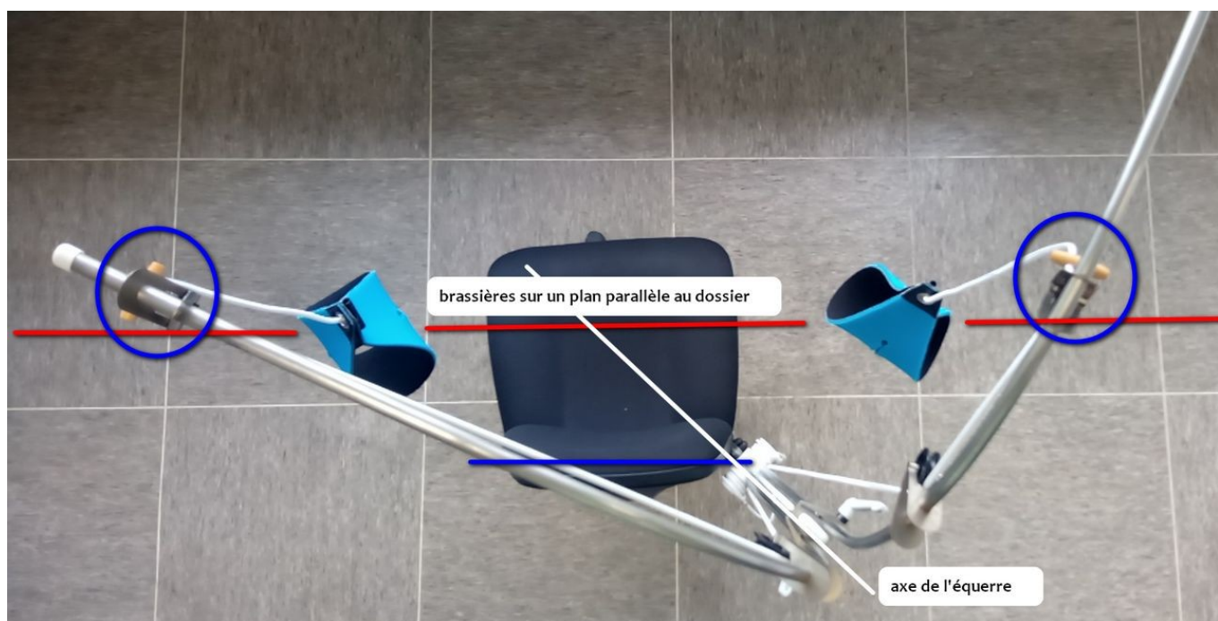
Image 11 : Dans ce cas, réglez la position des porte-poulies afin que les brassières arrivent à la verticale des coudes, dans un plan parallèle au dossier.
