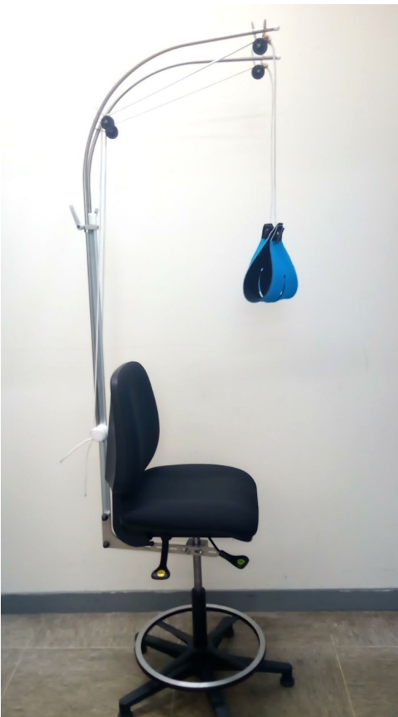
Image 35 : Perdelle-Swan est monté avec son équerre alignée avec l'axe du siège.
